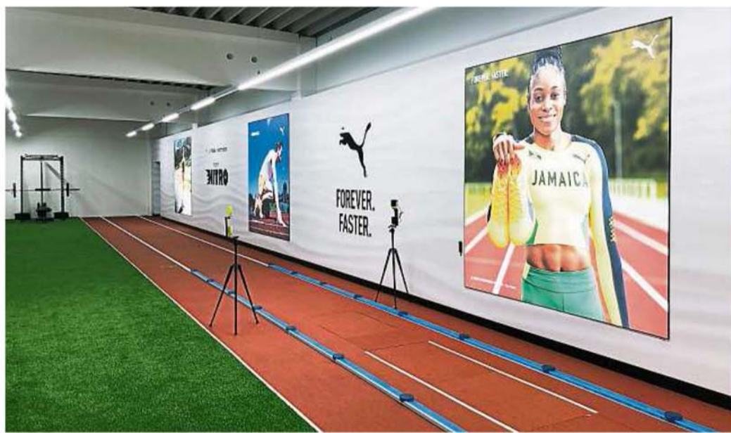
Modernste Technik: In der 60-Meter-Laufbahn verbaute Druckmessplatten, Lichtschranken und Hochgeschwindigkeits-Kameras sorgen für eine exakte Analyse von Bewegungsabläufen. Foto: Matthias Hartmann
